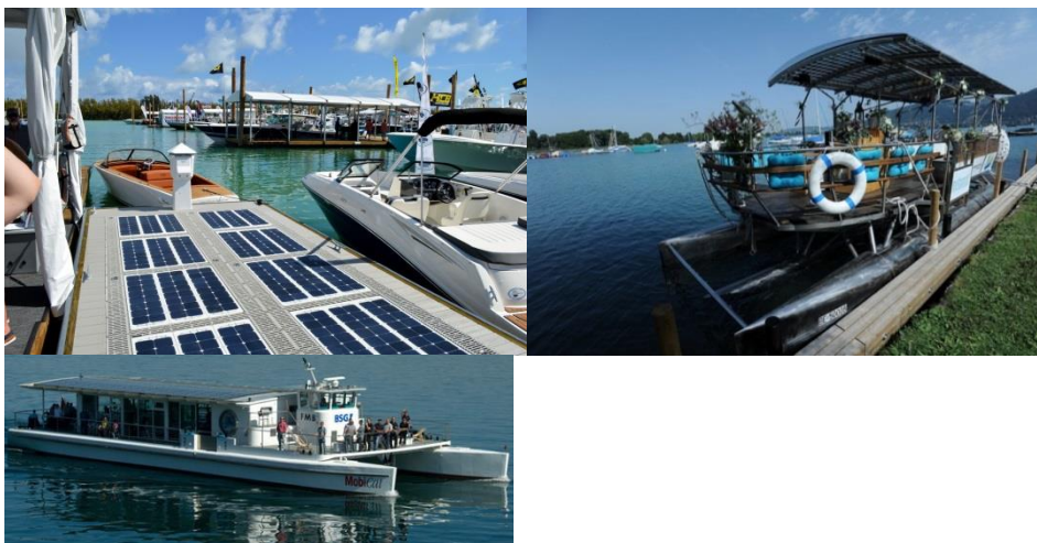
Abb. 50 Nutzung von Sonnenenergie für die Fortbewegung auf Gewässern. Beispielsweise bei Einsatz von Schiffen für den öffentlichen Personennahverkehr. Solarschiff „Thun“ (o. rechts [33]) und „MobiCat“ (u. links [34]). Am Steg angebrachte Photovoltaik kann netzunabhängig zusätzlichen Strom für die Batterien bereitstellen [35].
