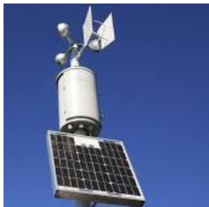
Abb. 40 Mit Solarzellen versorgte Wetterstation. [27] Neben Temperatur- und Feuchtesensoren kann auch ein WLAN-Module für eine Übertragung der Daten betrieben werden.
