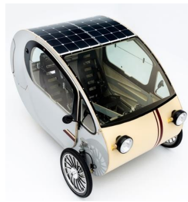
Abb. 41 Einbindung in das Mobilitätskonzept: Die Elektrifizierung des Verkehrssektors führt dazu, dass verstärkt damit experimentiert wird PV direkt in Fahrzeuge zu integrieren. Dies könnte für ein innovatives Carsharing / Bikesharing interessant sein. Die Abbildung zeigt ein „Light-electric-Vehicle“. [28]
