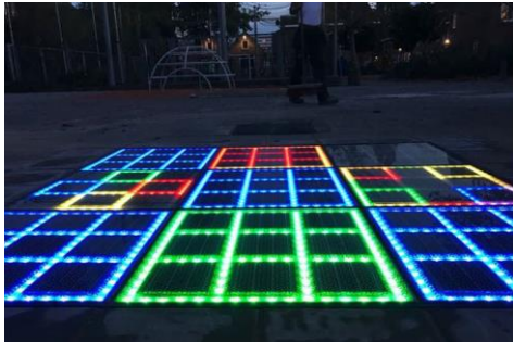
Abb. 12 The Gamer von der Firma Energy Floors. Jede der neun Solarplatten verfügt über eine Leistung von 35 Wp. [8]
