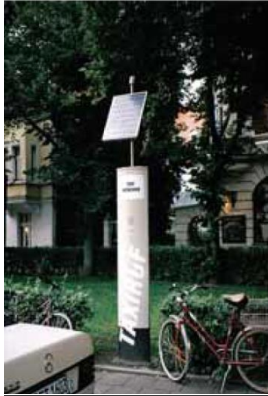
Abb. 32 Autonom solar betriebene Taxirufsäule in München. [5]
